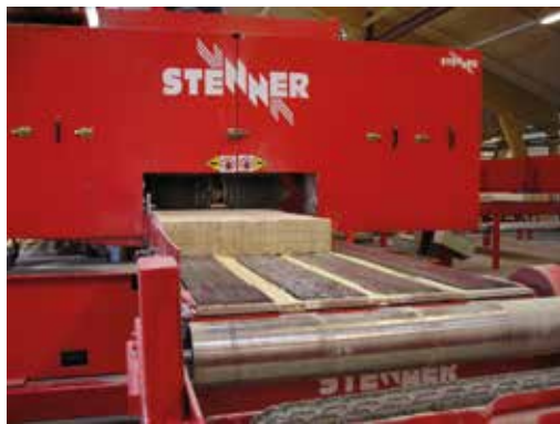
Horizontale bandzaag met brede opening
