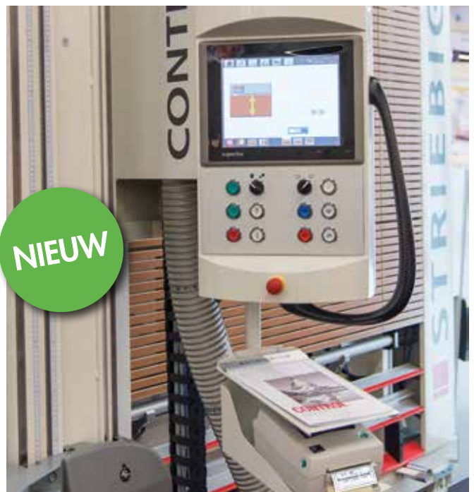
Nieuwe Control met optimalisatiesoftware en labelprinter.
