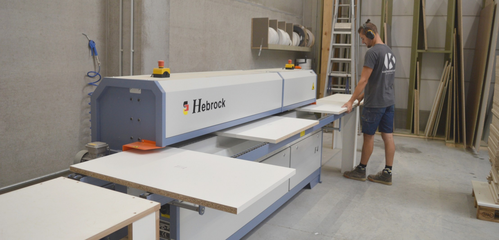
De Hebrock F4 kantenlijmmachine, geleverd door Noblesse, werd samen met de andere machines begin 2019 geïnstalleerd in het nieuwe magazijn in Baasrode
